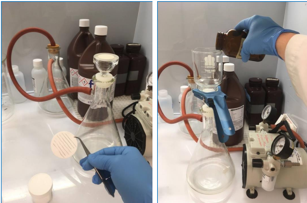
Figure 9 – Filtration sous vide des échantillons après la digestion oxydative de la matière organique.
