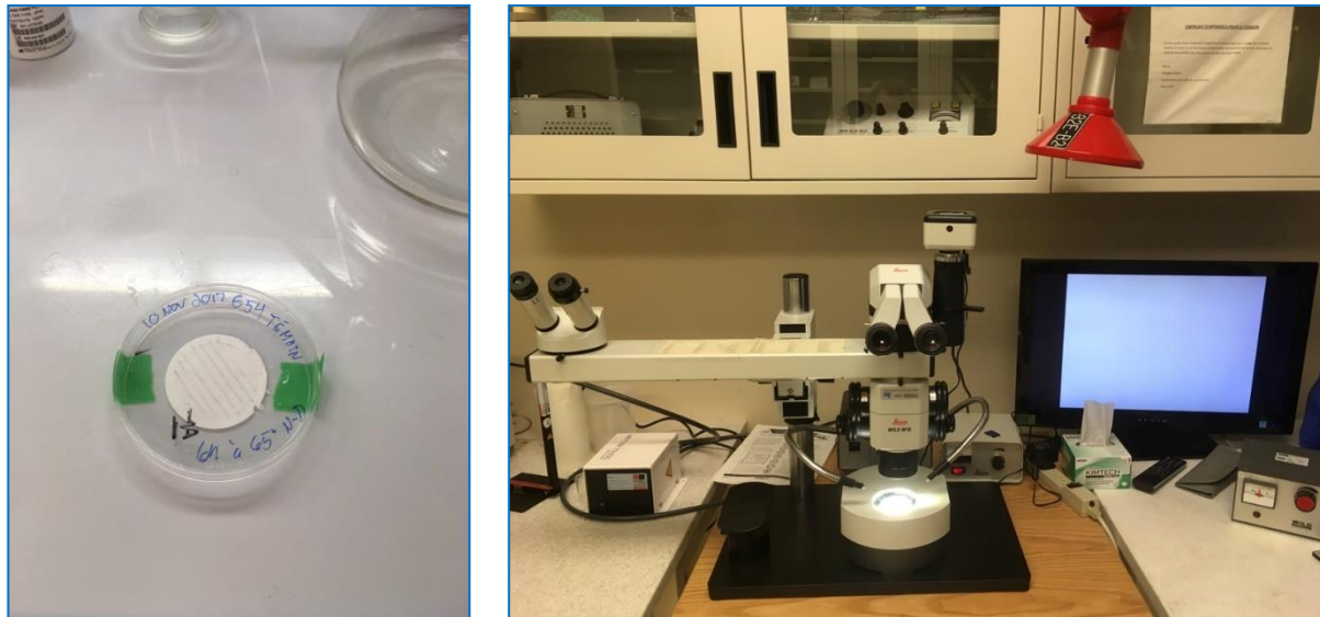
Figure 10 – Sur la photo de gauche : une boîte de pétri contenant les filtres à analyser une fois le traitement complété. Sur la photo de droite : le stéréomicroscope de l'INRS (Leica Wild M10, 80X). Une caméra connectée à l'appareil permet de visualiser sur un écran l'image du microscope.
