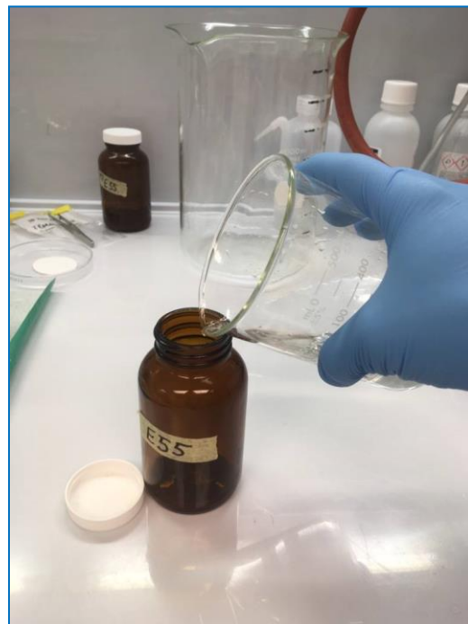
Figure 6 – Transfert de l'échantillon récolté dans le bocal en verre ambré de 250 ml.
